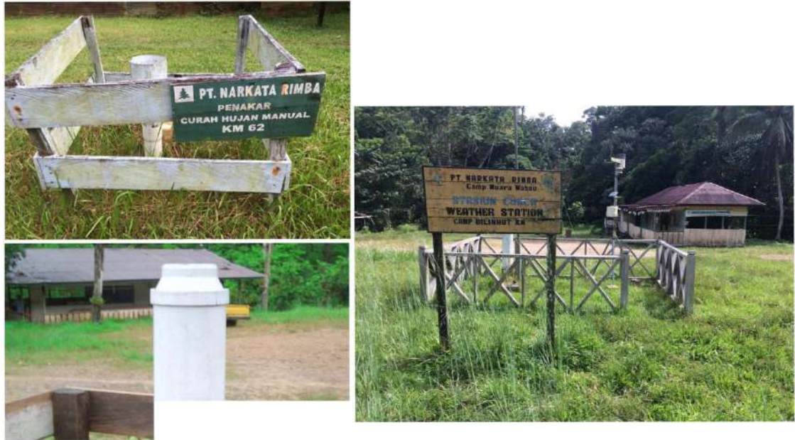
Gambar 10. Pengukuran curah hujan dan kecepatan angin
