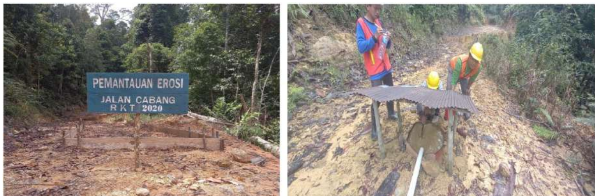
Gambar 8. Bak Erosi dan Penampungan material erosi pada drum
